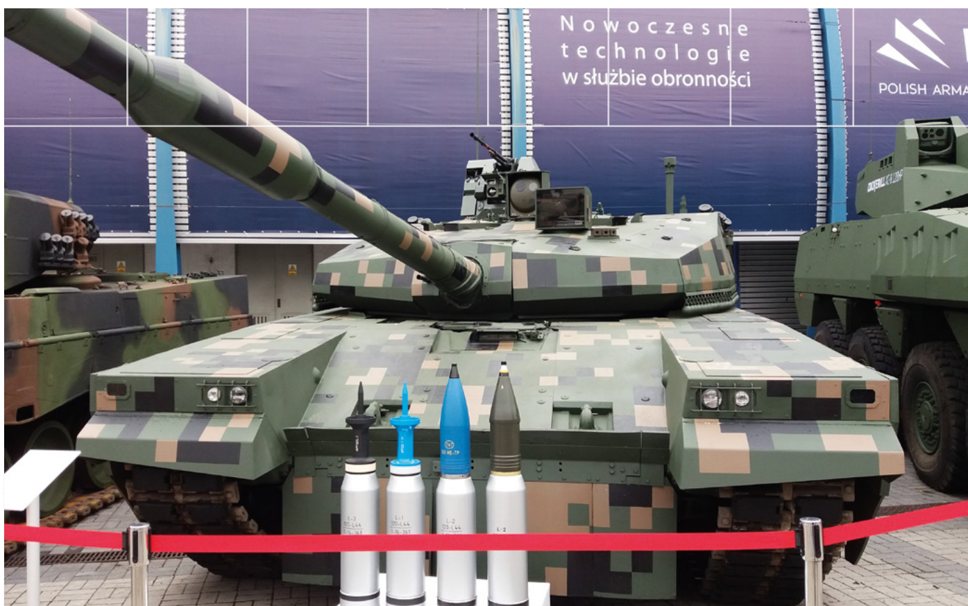
Inny wariant „T-72 NATO”, PT-16. Propozycja zakładała wykorzystanie bądź zupełnie nowej wieży, bądź tańszą modernizację istniejącej. (Fot. BK/WiT)
