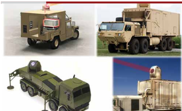
Wizja mobilnych przeciwlotniczych systemów laserowych do zwalczania małogabarytowych celów powietrznych na bliskich odległościach. Źródło: oprac. własne.
