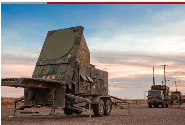
Radar ANM-PQ-53 używany w zestawach MM-104 (PAC-2). Polsce zaproponowana zostanie nowsza wersja ANM-PQ-65. Zdjęcie: Raytheon.
