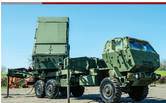
Radar kierowania ogniem (MFCR) systemu MEADS w wersji dla włoskiej armii. Zdjęcie: MEADS.
