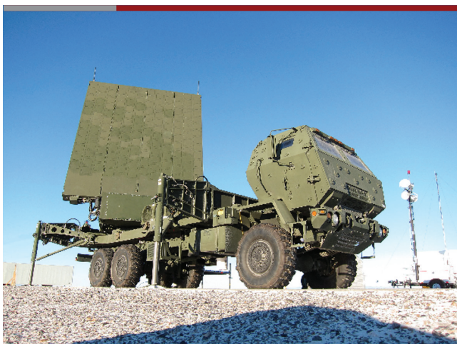
Radar dozoru przestrzeni powietrznej w wersji dla włoskiej armii. Zdjęcie: MEADS.
