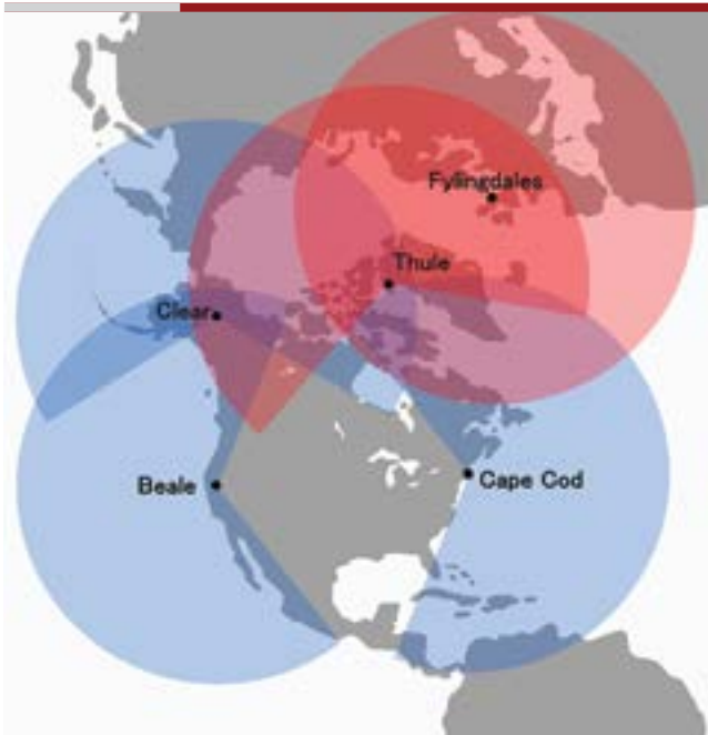
Grafika 6. Docelowy zasięg Zmodernizowanych Radarów Wczesnego Ostrzegania (UEWR). Jak dotąd zmodernizowano radary w bazach Thule, Fylingdales, oraz Beale, pozostałe dwa radary wczesnego wykrywania w Clear oraz Cape Cod mają zostać zmodernizowane odpowiednio do końca 2016 i 2017 r.
