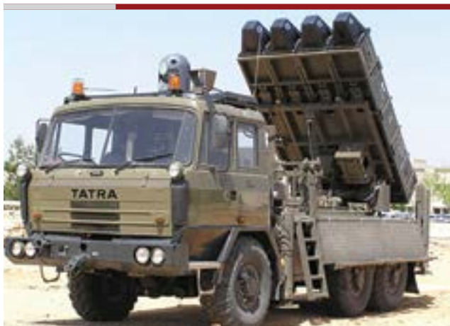
Grafika 30. Jednostka ogniowa systemu SPYDER SR zabudowana na podwoziu TATRA, wyposażona w głowicę optoelektroniczną TOPLITE Rafael. Autor: Rafael Advanced Defence Systems.
