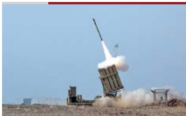
Grafika 26. Odpalenie pocisku rakietowego z wyrzutni systemu Iron Dome. Autor: Siły Obronne Izraela.
