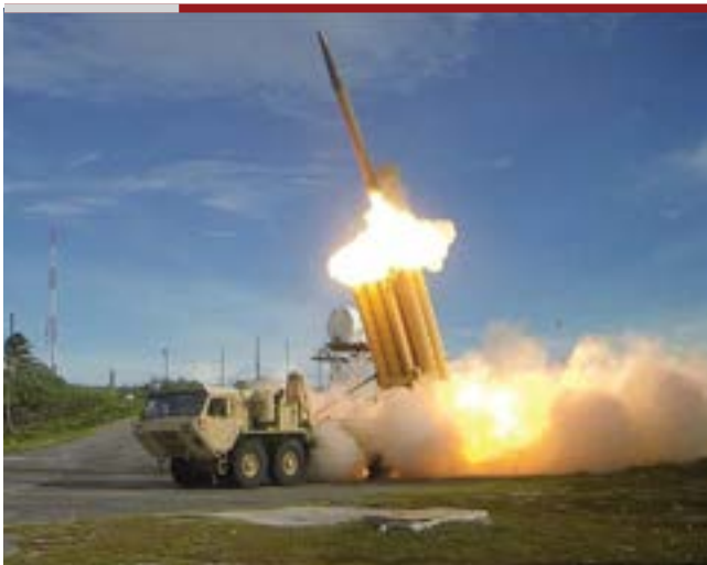
Grafika 3. Zestawy THAAD mają za zadanie zwalczać raketowe pociski balistyczne w ich końcowej fazie lotu. Pociski THAAD niszczą cele za pomocą energii kinetycznej, poprzez bezpośrednie uderzenie.
