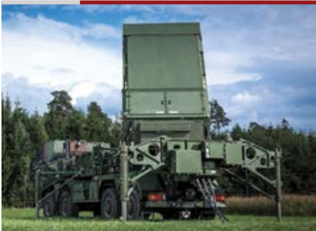
Grafika 21. Radiolokacyjna stacja kierowania ogniem MFCR zdolna do wykrywania obiektów zakresie 360°. Autor: MEADS International.
